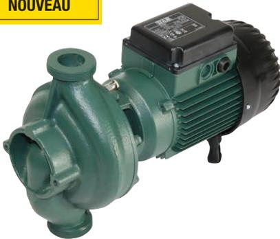
Pompes de circulation avec sorties en ligne, adaptées aux installations de chauffage, de climatisation et d'eau chaude sanitaire civiles et industrielles. Roue en technopolymère. Moteur asynchrone à 2 pôles pour la série **ALP** et 4 pôles pour la série **ALM**. Protection thermo-ampérométrique incorporée et condensateur permanent pour la version monophasée.
