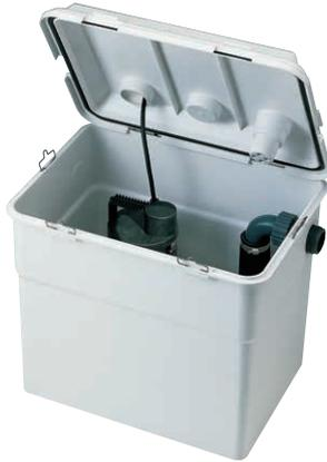
Unités de collecte et de relevage des eaux usées domestiques des baignoires, des lavabos, des douches et des lave-linge situés dans les sous-sols ou sous le niveau du réseau d'égouts en général. Elles possèdent une pompe NOVA 300 avec 5 mètres de câble d'alimentation et une fiche montée sur une plaque en technopolymère, une cuve de 30 litres en technopolymère et un clapet anti-retour sur le refoulement. L'unité de relevage est fournie prête à l'emploi.
