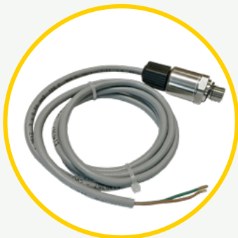
CAPTEUR DE PRESSION 4-20 MA - 25 BAR
